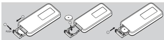
sfilare il porta-batteria, sostituire la batteria (rispettando la polarità) e richiudere il porta-batteria. Per lunghi periodi di inattività del telecomando togliere la batteria.
