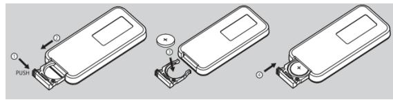
extraiga el porta-batería, sustituya la batería (respetando la polaridad) y vuelva a cerrar el porta-batería. En caso de largos períodos de inactividad del mando a distancia extraiga la batería.
