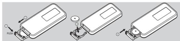
ziehen gleichzeitig den Batteriehalter heraus. Ersetzen Sie die Batterie (unter Beachtung der Polarität) und schließen Sie den Batteriehalter wieder. Wird die Fernbedienung längere Zeit nicht benutzt, sollten Sie die Batterie herausnehmen.
