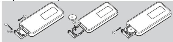
le compartiment pile, remplacer la pile (en respectant la polarité) et refermer le compartiment pile. Si la télécommande ne doit pas être utilisée pendant de longues périodes, retirer la pile.
